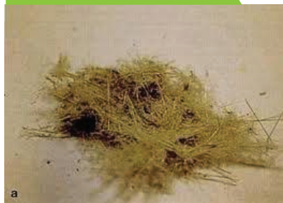
CRISOTILO O ASBESTO CAFE
